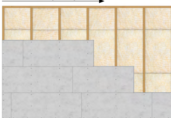
Eksempel på Swisspearl Windstopper Connect med forskjøvede skjøter
