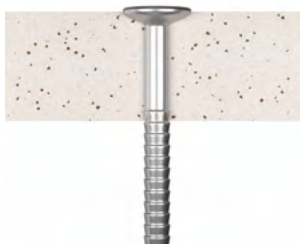
montering med spiker: Swisspearl Windstopper 4,5 mm og 9,0 mm
