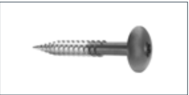
Fasadni vijak Swisspearl za les Brez podložke SCR-W 4,8 x 40 mm Nerjavno jeklo A4 (Linija Swisspearl Patina)
