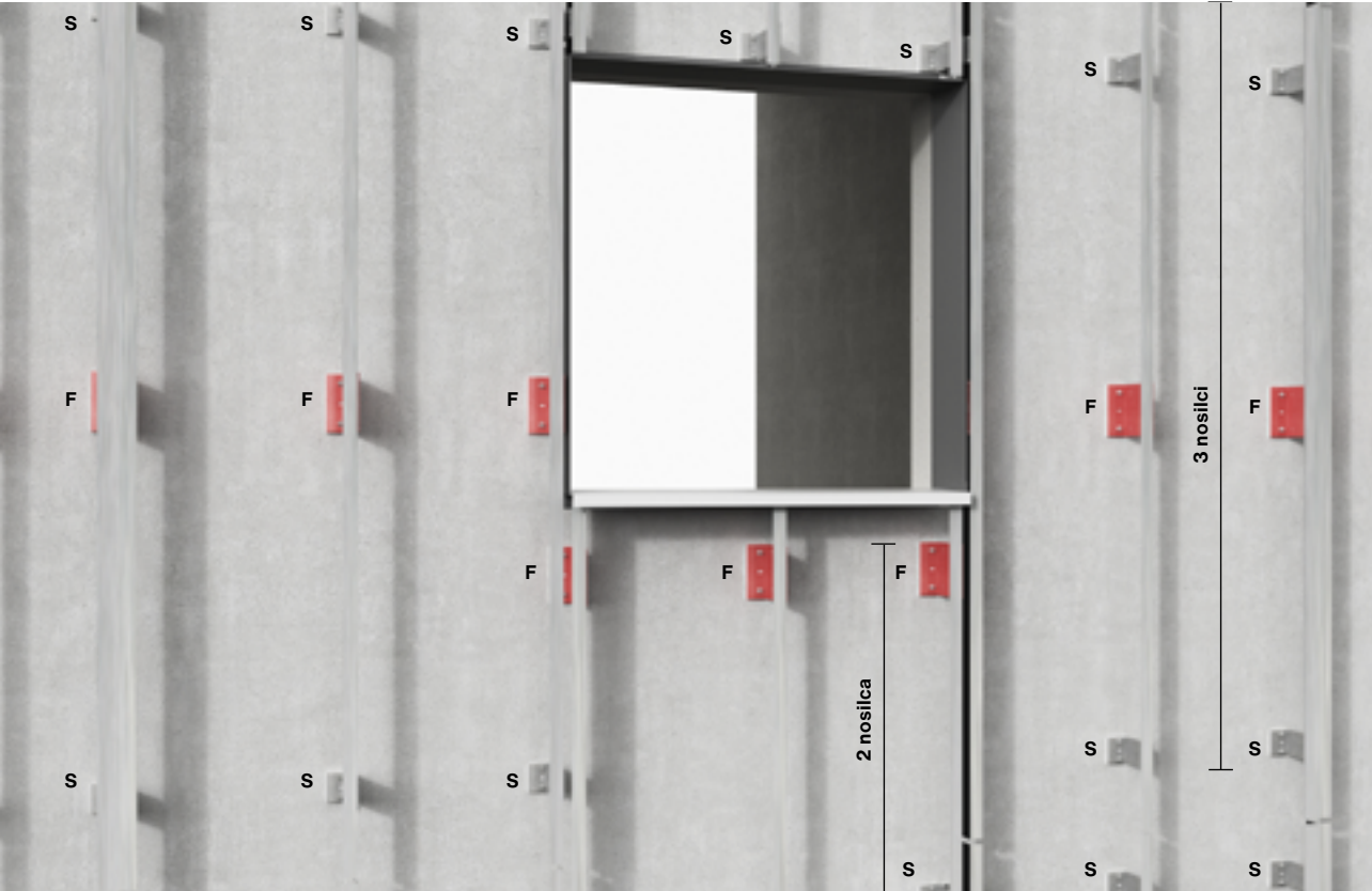
Rdeči nosilci so nosilci s pritrdilnimi točkami (F)
