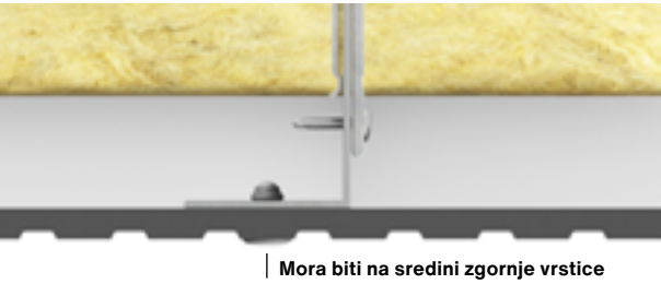
Slika 2: Vgradnja Swisspearl Patina Inline na L-profil.
