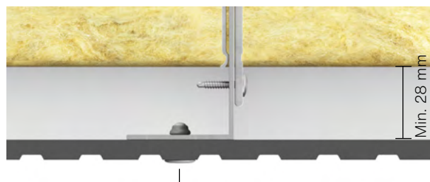
Fig. 2. Swisspearl Patina Inline plaatsing op een L-profiel.
