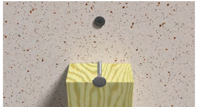
Keskirangan kohdalla varmista, ettet kiinnitä liian lähelle levytyksen vaakareunaa.
