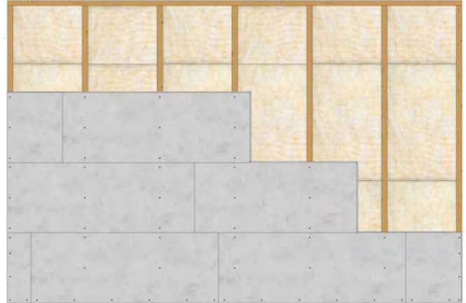
Esimerkki Swisspearl Windstopper Connectista porrastetuilla pystysau- moilla
