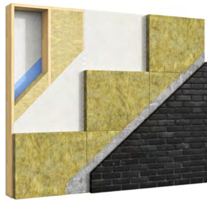
Tyypillinen rakenne Swisspearl Windstopper -levyille
