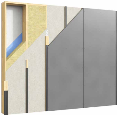
Voorbeeld van een lichte wandconstructie met een A1-classificatie Swisspearl Windstopper Extreme 9,0 mm die ook een kapselcriterium heeft van K 1 10 B - s1, d0, K 2 10
