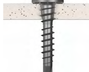
schroef plaatsen: Swisspearl Windstopper 4,5 mm
