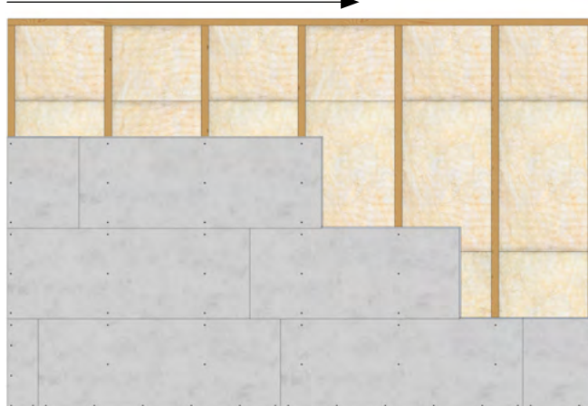
Voorbeeld van Swisspearl Windstopper Connect met verspringende voegen
