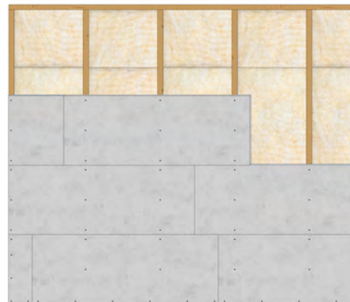
Voorbeeld van Swisspearl Windstopper Connect met verspringend patroon
