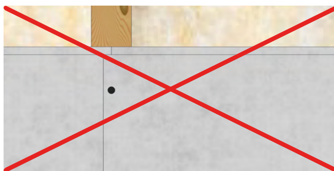
Vermijd het plaatsen van voegen direct boven verticale steunen
