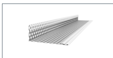
10. Prezračevani profil Swisspearl 0,6 mm perforirano jeklo, dolžina 3000 mm
