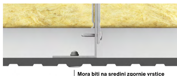
Slika 2: Vgradnja Swisspearl Patina Inline na L-profil.
