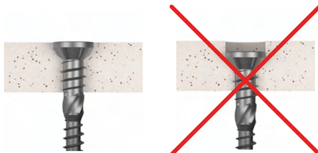
skrūvju uzstādīšana: Swisspearl Windstopper 9.0 mm
