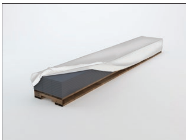
Kalkkihärmän muodostumisen välttämiseksi, poista muovinen pakkausmateriaali kun lavat on toimitettu työmaalle.
