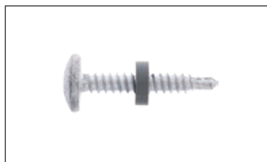
Swisspearl Universal ruuvi piilokiinnitys teräsrankaan (1,2–3,0mm) 4,2x30 mm
